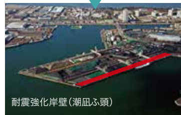
耐震強化岸壁(潮見ふ頭) 潮見ふ頭2バース(全長315m) 大江ふ頭1バース(全長185m)
